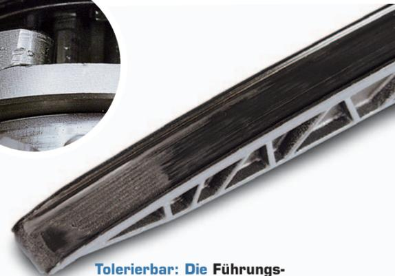
Tolerierbar: Die Führungsschiene des Steuerkettenspanners zeigt geringen Materialabrieb
